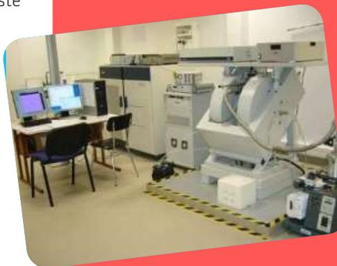
La spectroscopie de Résonance Paramagnétique Electronique (RPE) est une technique centrale de caractérisation des propriétés électroniques, magnétiques et structurales des systèmes en sciences de la matière et en sciences de la vie.
